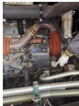
低怠速启动发动机一分钟左右,使机油循环,然后停止发动机。等待一小段时间使机油流回发动机油底。检查机油油尺上的油位。启动发动机并检查是否有泄漏。发动机油槽和滤清器容积(总容积)
