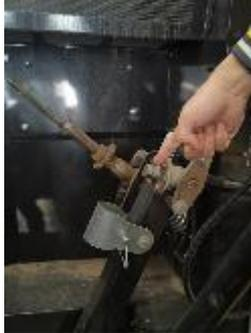
15) 从切碎器皮带轮(15)上卸下皮带(14)。将皮带(14)放入安全位置中，如图所示。
