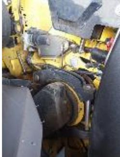
21) 使用拖拉机缓慢提升切碎器主体，观察其越过切碎器主体支撑座的底部之后，在缓慢向前开动拖拉机。
