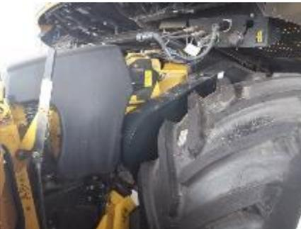
7) 在左侧，断开两个切碎机体液压管路(7)。
