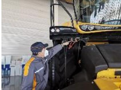
12) 拆下位于机器保养区中的支架(11)。注意：请勿改变皮带张力。为了能安装支架(11)，请将破碎器(CP)切换至“草”的位置。
