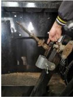
14) 松动螺杆(13)。注释：螺杆上的螺纹长度约为300 mm (11.81 in)，注意不要将螺杆全部旋出。大约将螺杆旋出150mm左右主皮带就可以完全松开。
