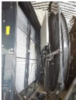
根据不同的工作条件定期用压缩空气清洁冷却系统。
